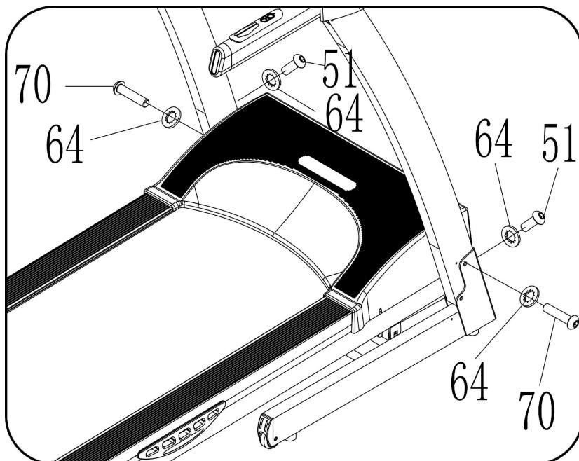
1. Установите стойки на основной раме, зафиксировав с помощью болтов M8\*45 (70) и стопорных шайб (64), используя шестигранный ключ 5#.
