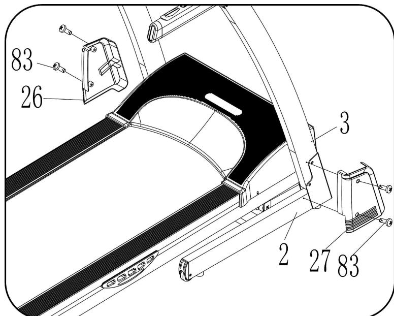
Зафиксируйте крышки (26/27) на раме с помощью болта ST4.2\*19 (83), используя гаечный ключ с отверткой.
